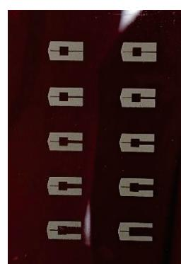
プラスティック基板上へ直接印刷で製作したパターン
