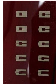
ステップインピーダンス共振器（SIR）構造を採用し、広い帯域幅（大きな情報量）を実現
